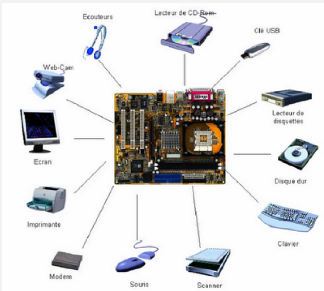
CODE I1.1: Schéma: unité centrale et ses périphériques
